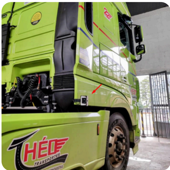
Câmera Externa de Monitoramento
